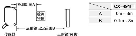
(注3): 如果安装了狭缝透光罩(另售), 可检测φ0.5mm的小物体(使用圆形狭缝透光罩时)。
